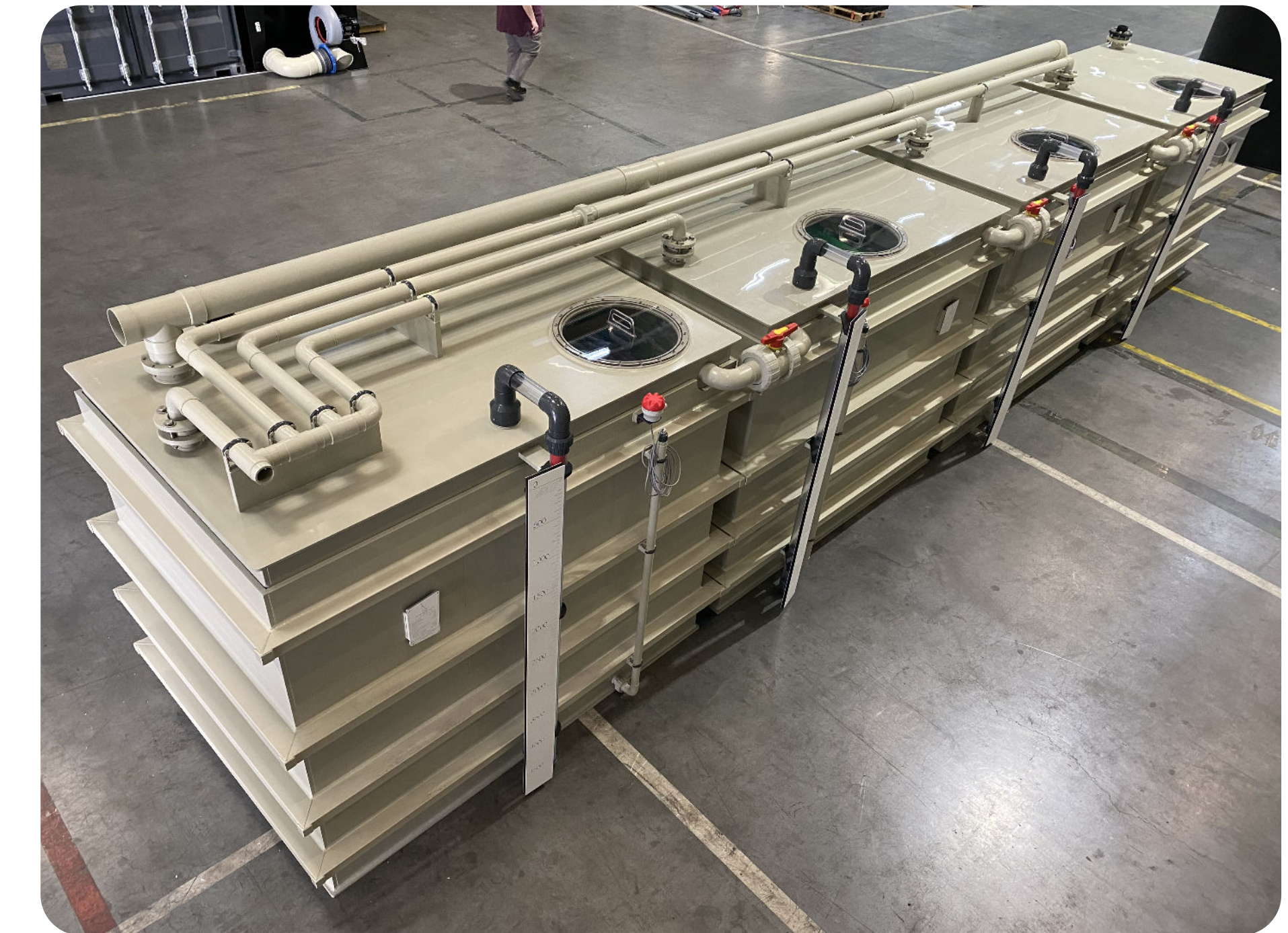
Bac de traitement
